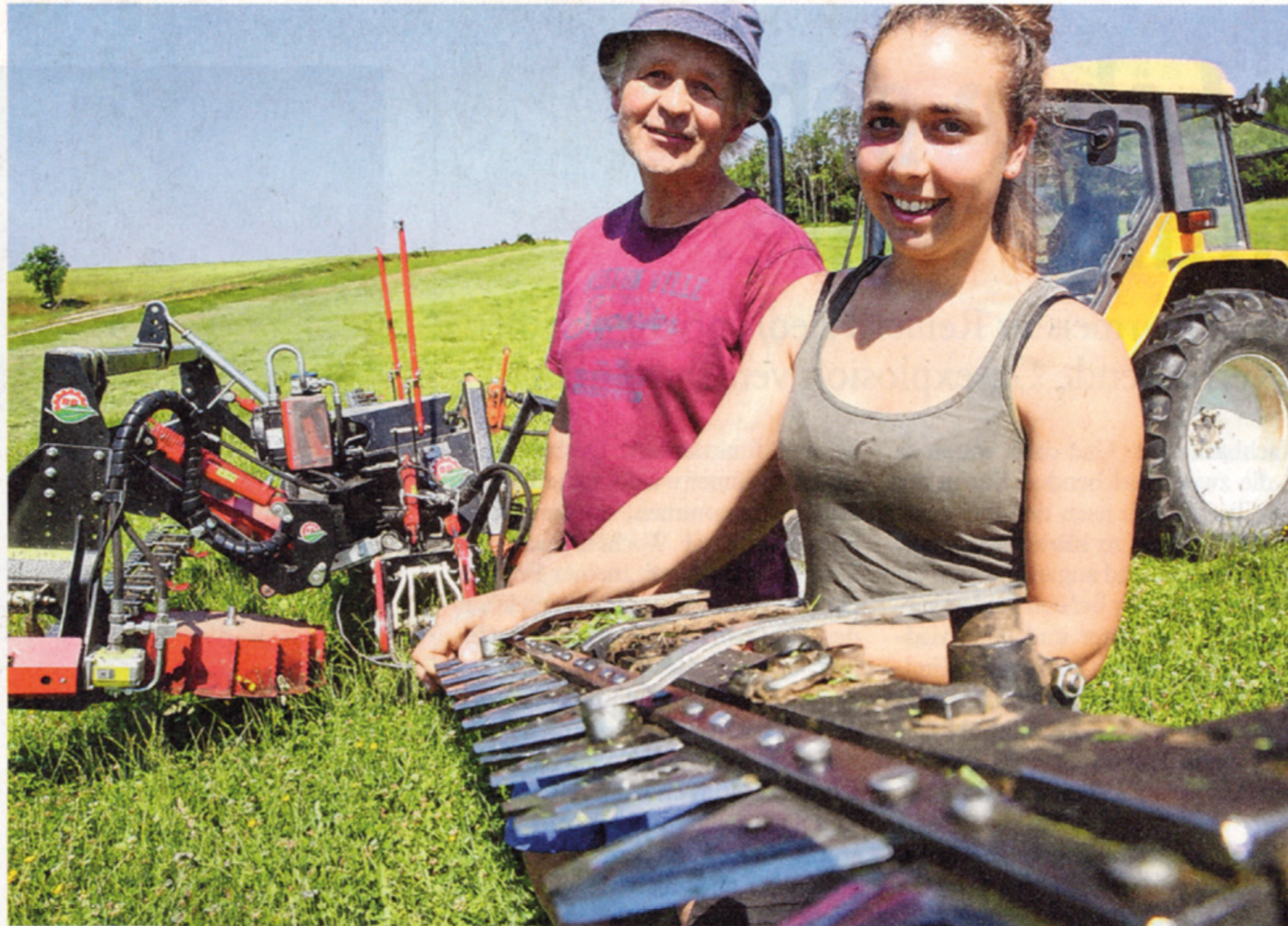
Landwirt Manfred Gabler und Azubi Elisabeth Berchtold begutachten die Messer des Mähwerks. Sie müssen regelmäßig geschärft werden.
